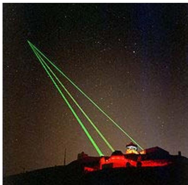
場合、地球の大気揺らぎによって星像がぼやける（シンチレーション）現象が発生し、空間分解能が制限されてしまう。この分解能を上げるには、揺らぎによる影響を光学的に補償するシステムが必要となる。
